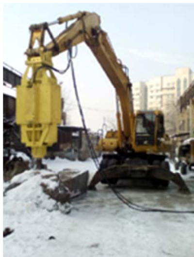
Рис. 1. Испытания электромагнитного молота на экскаваторе и на стенде
