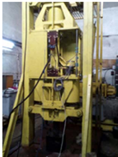
Рис. 1. Испытания электромагнитного молота на экскаваторе и на стенде
