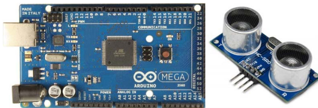
Рис. 2. Контроллер «Arduino Mega 2560» и цифровой датчик
